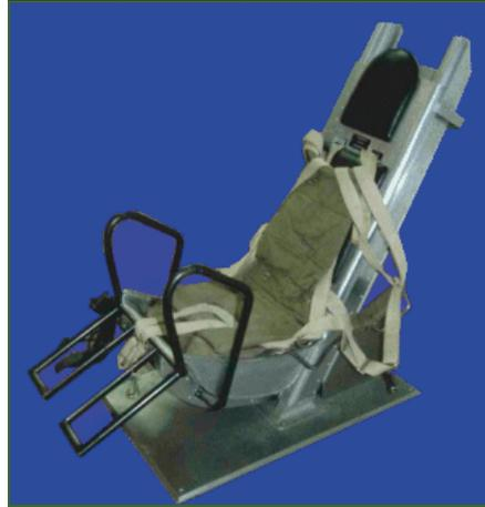
Ese asiento iba montado sobre tubos paralelos de un metro de largo. Cada tubo contenía una carga de pólvora.
